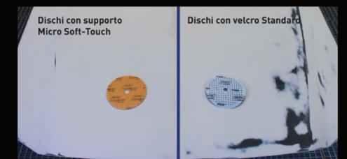
Consente una finitura più compatta, senza 'sfondare' bordi e spigoli. Il supporto Micro Soft-Touch garantisce un ottimo abbassamento della buccia del fondo per un'eccellente finitura superficiale.
